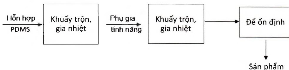
Hình 1. Sơ đồ phối trộn tạo dầu phanh DOT 5
