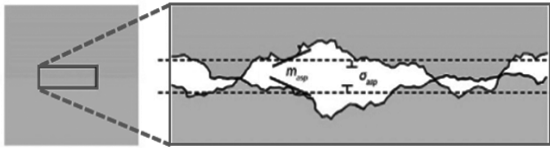
Hình 3. Minh họa tiếp xúc giữa hai chi tiết [9]
