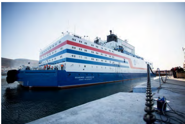
Hình 1. Nhà máy điện hạt nhân nổi Akademik Lomonosov với hai mô-đun lò phản ứng KLT-40S đã được kết nối với lưới điện và bắt đầu vận hành thương mại vào tháng 5 năm 2020
