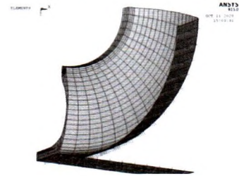
Hình 2.2: Mô hình tiếp xúc giữa bề mặt tang trống và lốp
