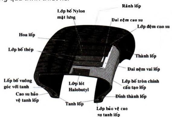
Hình 1.1: Cấu tạo lốp ô tô
