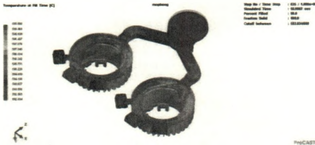
Hình 10. Phân bố nhiệt của trường hợp V = 0,7 m/s; T = 650^\circ\text{C}
