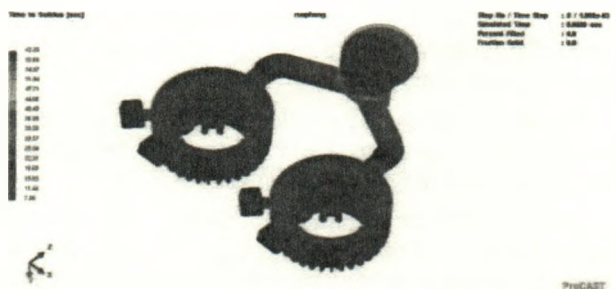
Hình 5. Thời gian đông đặc của trường hợp V = 0,7\text{ m/s} , T = 700^{\circ}\text{C}
