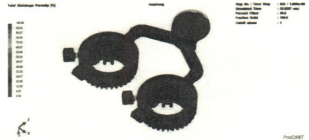
Hình 11. Độ co ngót trong trường hợp V = 0,7 m/s; T = 650^\circ\text{C}
