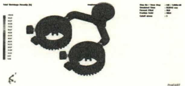
Hình 8. Độ co ngót của trường hợp V = 1\text{ m/s} , T = 700^{\circ}\text{C}
