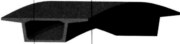
Hình 3.3: Dạng dao động mode 1 của kết cấu nhịp
