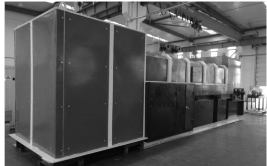
Hình 2. Máy tuyển tuyển than bằng tia X tại NMTT PingShang (Trung Quốc)
