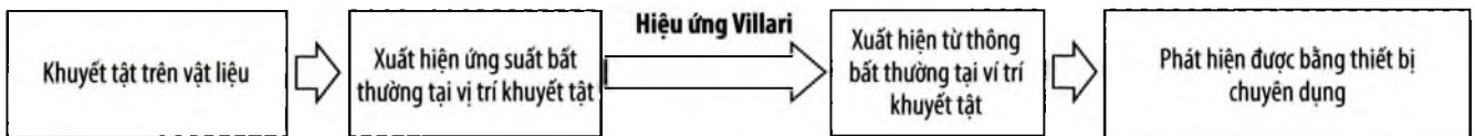
Hình 3. Sơ đồ nguyên lý ứng dụng hiệu ứng Villari trong phát hiện khuyết tật vật liệu từ
