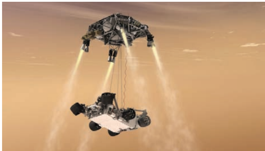
Hệ thống bay phản lực thả neo để robot tự hành Perseverance hạ cánh xuống bề mặt sao Hỏa (Nguồn: NASA/JPL-Caltech).
