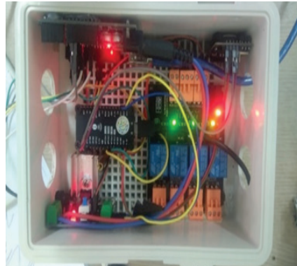
Hộp điều khiển và hệ thống trồng nấm thông minh do Trung tâm chế tạo.
