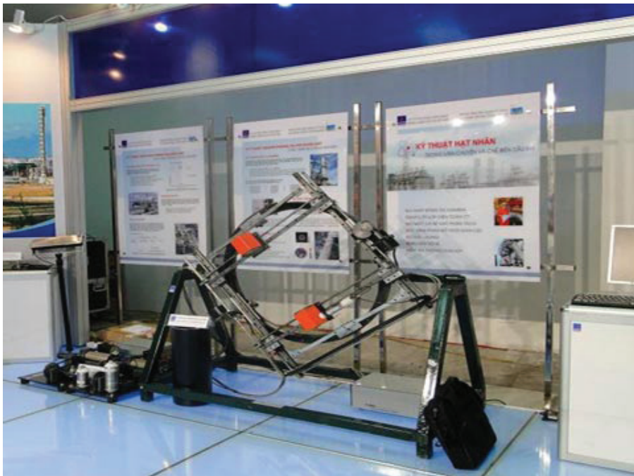
Thiết bị chụp cắt lớp điện toán (CT) trong công nghiệp do Trung tâm Ứng dụng kỹ thuật hạt nhân trong công nghiệp (CANTI) thiết kế chế tạo đã được xuất khẩu sang nhiều quốc gia trên thế giới.
