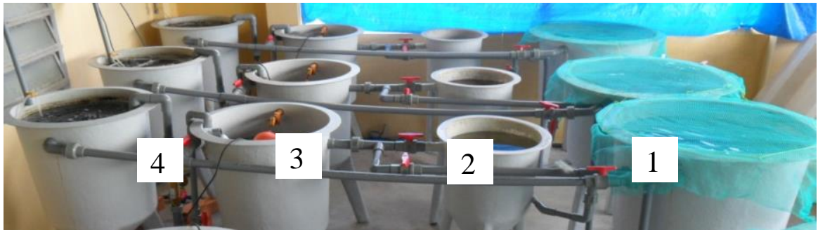
Hình 2. Hệ thống lọc giá thể chuyển động dùng trong thí nghiệm
