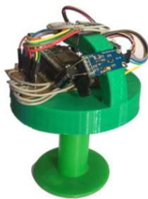
Hình 1. Hình ảnh của hệ thống cảm biến ánh sáng quay đa hướng
