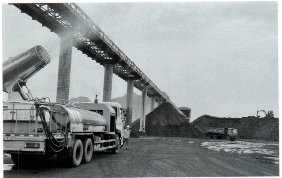
Xe Phun sương cao áp dập bụi hoạt động tại cảng Km6 của Công ty Kho vận và Cảng Cẩm Phả Vietsovpetro.
