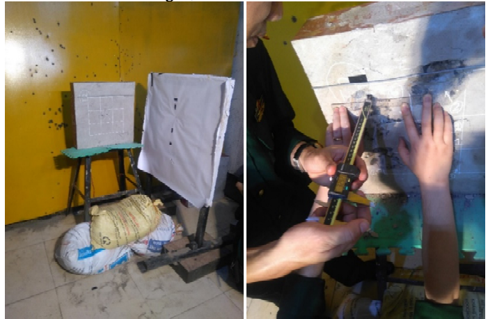
Hình 4. Tiến hành đo kết quả trên tấm chắn bê tông chịu tác dụng của đạn AK 7,62 mm.
