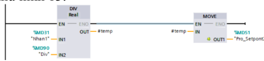
Hình 14. Chương trình nhận dữ liệu từ PLC Client 1 và truyền dữ liệu tới PLC Client 2
