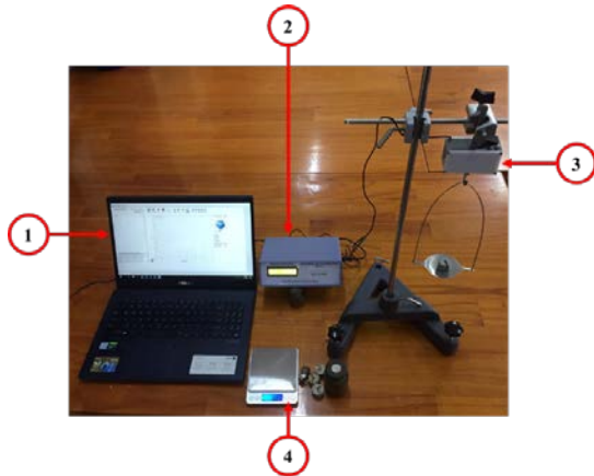
Hình 11. Thí nghiệm khảo sát độ chính xác của cảm biến khoảng cách. (1) Giao diện tương tác, (2) Hộp hiển thị, (3) Hệ thống cố định cảm biến lực, (4) Cân tiểu li và gia trọng
