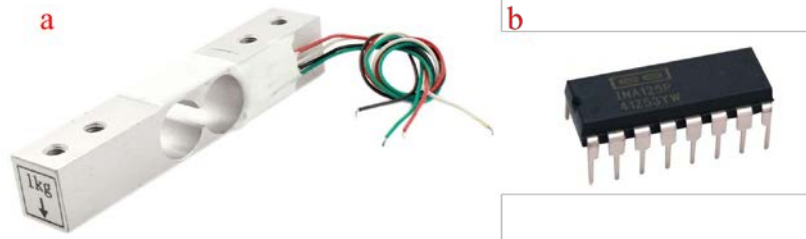
Hình 5. (a) Cảm biến lực YZC131-1kg; (b) Mạch khuếch đại vi sai INA125P
