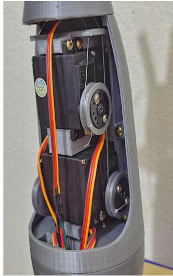
Hình 9. Hình ảnh khối động cơ của hệ thống
