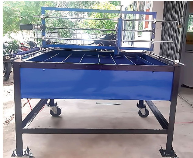
Hình 16. Máy cắt plasma hoàn thiện
