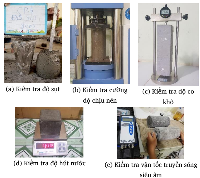
Hình 2. Hình ảnh kiểm tra một số tính chất của hỗn hợp bê tông và bê tông.
