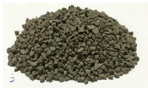
Hình 2.3b. Hạt cốt liệu từ tro bay kích thước nhỏ hơn 4,5 mm.
