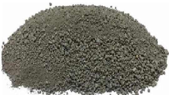
Hình 2.3a. Hạt cốt liệu tro bay kích thước nhỏ hơn 2,5 mm.
