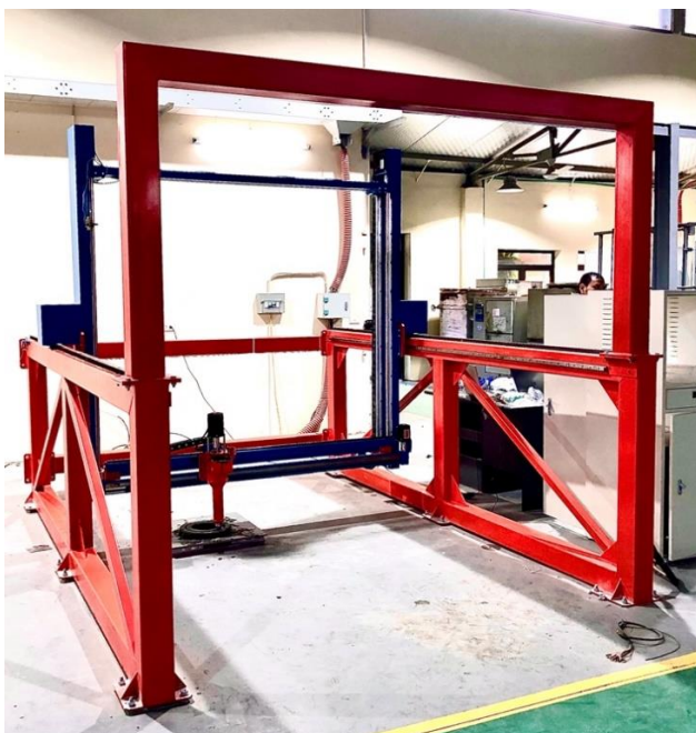
a) Máy in 3D bê tông
