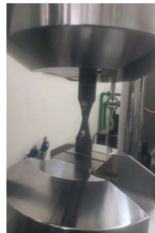
Hình 2. Mẫu được tạo ứng suất dư bằng nhiệt
