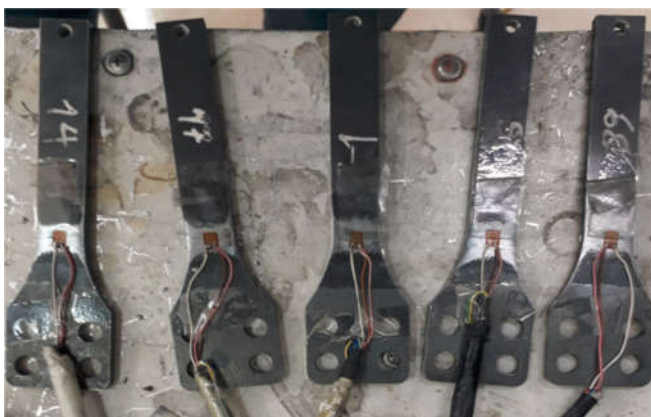
Hình 5. Tem đo biến dạng được dán trên mẫu
