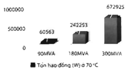
Hình 4. Các loại tổn thất máy biến áp ở Nhà máy Điện Nhơn Trạch 2
