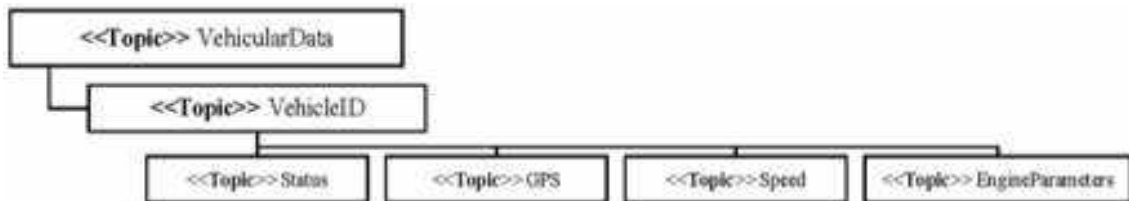
Hình 3. Các chủ đề thông tin (MQTT Topics) thiết kế cho phương tiện trong hệ thống
