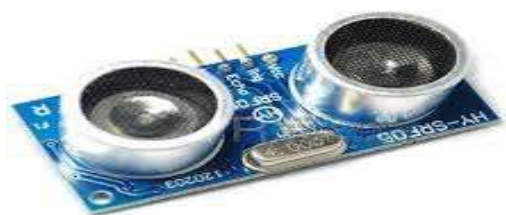
Hình 10. Module cảm biến siêu âm SRF05
