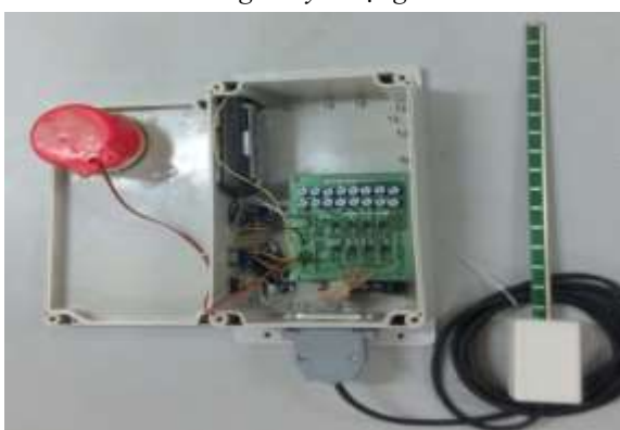
Hình 12. Hình ảnh thực tế hộp cảm biến và xử lý thiết bị mưa
