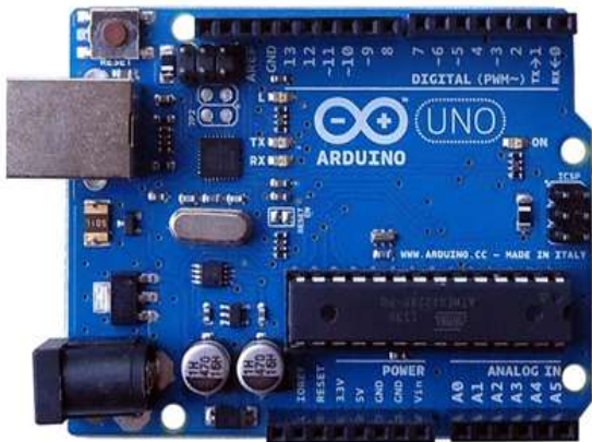
Hình 7. Hình ảnh vi xử lý Arduino UNO
