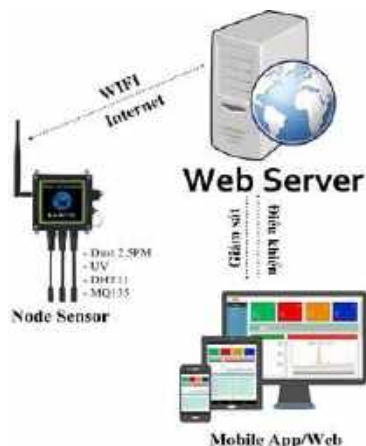
Hình 2. Sơ đồ hệ thống triển khai
