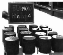
Hình 3.3: Trộn và đầm nén mẫu đất gia cố sử dụng đầm xoay
