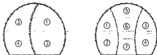
Hình 3.1: Chia gương đào bằng phương pháp vách chống đỡ giữa và hang dẫn bên
