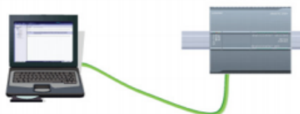
Hình 19. Ghép nối PC - PLC S7.1200
