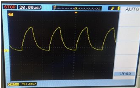
Hình 14. Kết quả dạng tín hiệu điện áp ra trên tải đèn huỳnh quang
