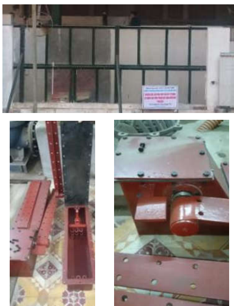
Hình 14: Mô hình máng kính thí nghiệm cửa van bản lật
