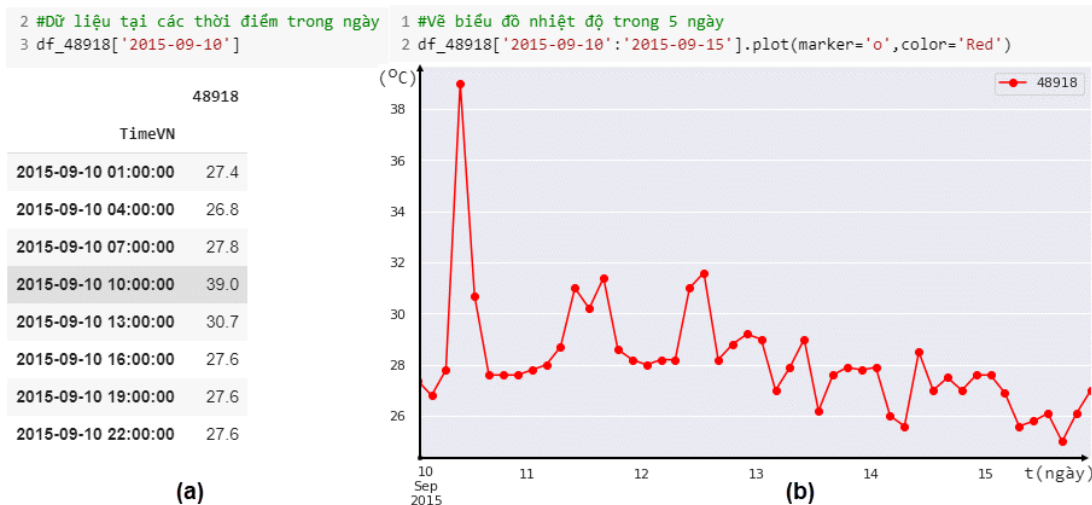
Hình 12. Kiểm chứng điểm ngoại lai phải có giá trị cao nhất tại trạm 48918.
