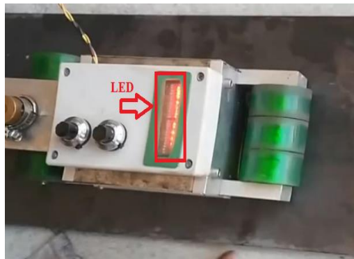
Hình 16. Kiểm tra tốc độ kéo MFL với tốc độ kéo 1.0m/s
