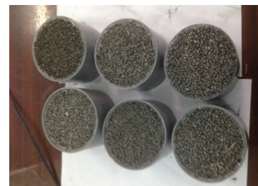
Hình 5. Bê tông rỗng sau khi chế tạo.
