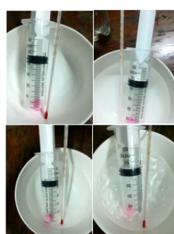
Hình 3. Bộ thí nghiệm kiểm chứng định luật Gay Lussac
