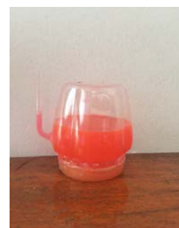
Hình 4. Mô hình dự báo thời tiết phong vũ biểu
