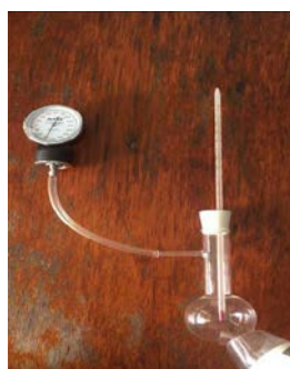
Hình 2. Bộ thí nghiệm kiểm chứng định luật Charles
