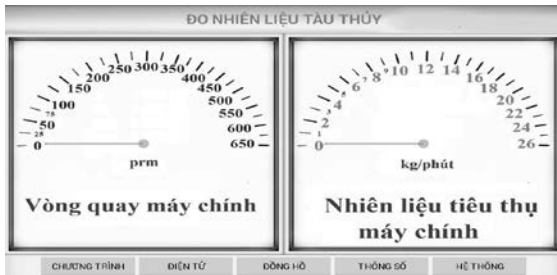
Hình 13. Đồng hồ hiển thị vòng quay và nhiên liệu tiêu thụ máy chính.
