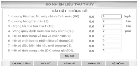
Hình 12. Cài đặt các thông số tàu vào phần mềm đo nhiên liệu tiêu hao máy chính.
