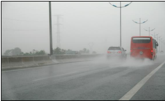
Hình 1. Hiện tượng bắn nước sau bánh xe khi mặt đường ẩm ướt.
