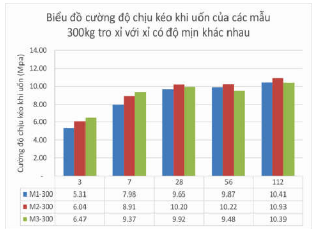
Hình 10: Biểu đồ quan hệ giữa cường độ chịu kéo khi uốn và tuổi mẫu của các mẫu bê tông sử dụng 300kg tro + xi với xi có độ mịn khác nhau
