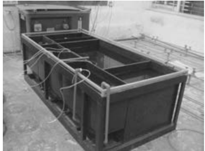
Hình 4. Mô hình được cấp nước để kiểm tra độ kín khí
