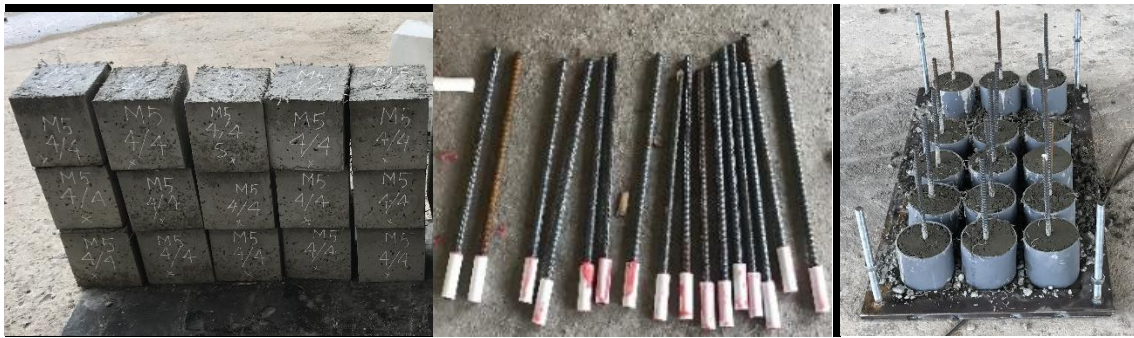
Hình 2. Chuẩn bị mẫu thử cường độ nén và bám dính của cốt thép với bê tông
