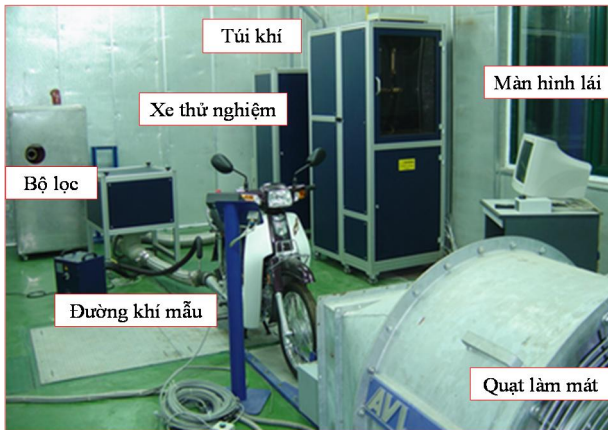
Hình 3. Hệ thống thử nghiệm
