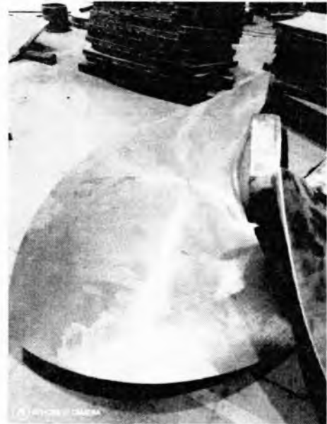
Hình 6. Cánh turbine sau khi hàn lên trục và đánh bóng
