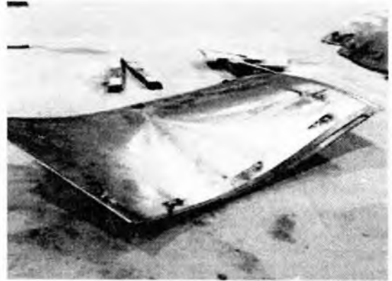
Hình 5. Cánh turbine sau khi phay CNC
