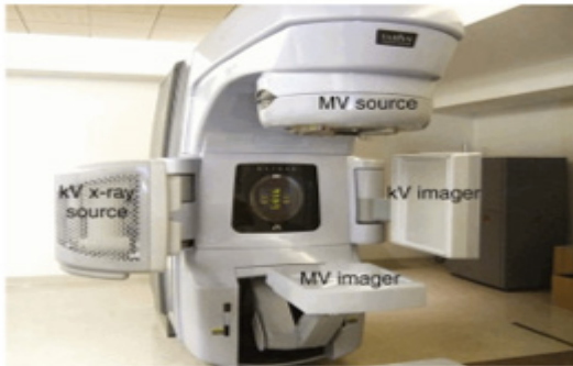
Hình 3: các hệ thống định vị bằng tia X tích hợp với máy xạ trị Varian, BrainLab.
