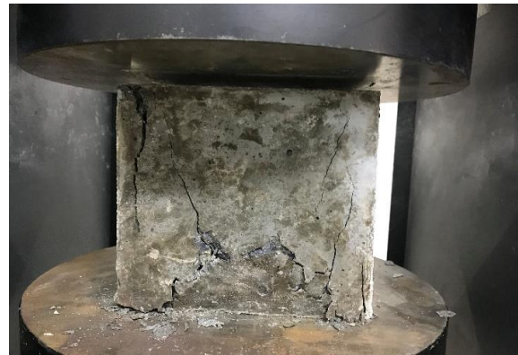
Hình 4. Mẫu bê tông bị phá hủy.
