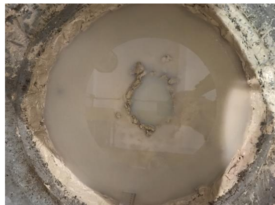
Hình 1. Sơ đồ chung của thiết bị trong mô hình hóa các vụ nổ, các lượng nổ tập trung trong đất sét dưới nước (a); ảnh chụp kết quả sau nổ (b). (1- bề mặt nền đất; 2- bể kim loại; 3- đất sét; 4- bề mặt nước; 5- mức tương đương của bề mặt tự do khi thay thế nước về đất sét; 6- lượng nổ).
