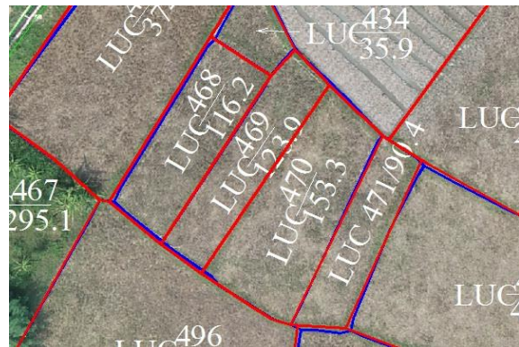
Hình 7. Ranh giới thửa khi so sánh với nền ảnh (màu đỏ là ranh giới thửa vẽ từ dữ liệu ảnh UAV và màu xanh là ranh giới thửa trên bản đồ do Sở TN&MT cung cấp).
