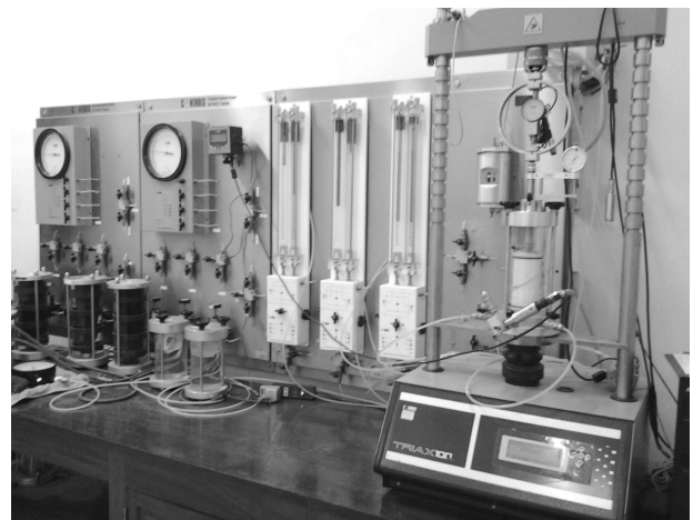
Hình 1. Hệ thống máy ba trục cải tiến dùng trong phòng thí nghiệm Địa kỹ thuật, trường Đại học Thủy lợi
