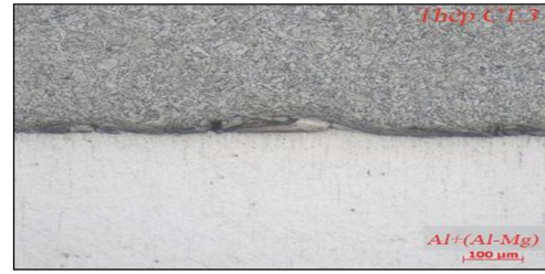
d) Fe - Al, x100 (Mẫu số 06) \sigma_{b,d} = 61,4793\text{MPa}
