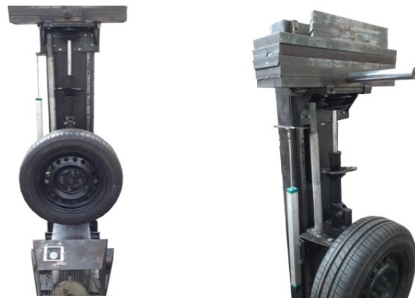
Hình 3b. Thiết bị xác định các thông số kết cấu của HTT và mô phỏng lại mô hình dao động ¼ xe thực tế
